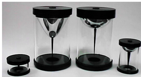
FIG. 1.13 – Famille de capteurs catadioptriques.
