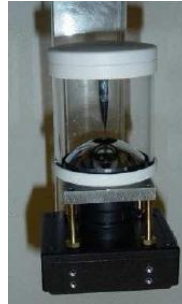
FIG. 1.24 – Combinaison d'un miroir parabolique avec un miroir sphérique.
